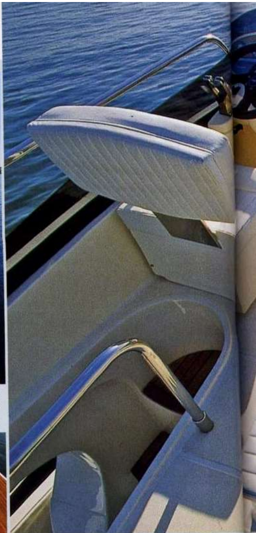
Sopra, uno dei due passavanti che, grazie alle solide battaglie, permettono di passare in sicurezza dal pozzetto fino a prua.
